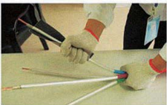
13、用砂纸去除铝管表面的氧化物
