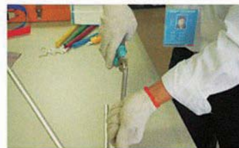
8、使用切管钳（滚刀）将铝管割出痕迹并且不得损坏云母，以便铝管的剥除
