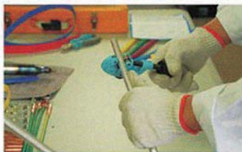
8、使用切管钳（滚刀）将铝管割出痕迹并且不得损坏云母，以便铝管的剥除
