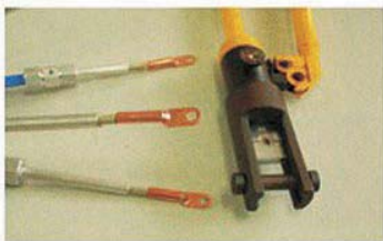
19、使用合适的铜鼻子，将其套入剥好云母带后的线芯
